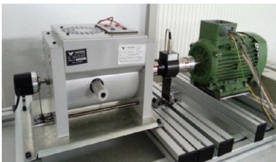
3.1 – сурет - Асинхронды қозғалтқыштың негізгі сипаттамаларын алуға көмектесетін қондырғының үлгісі [8].
